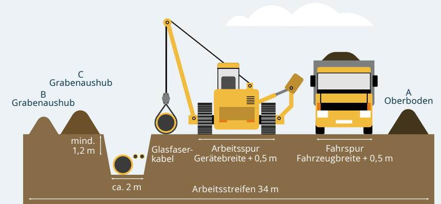
Im Zuge der Bauarbeiten wird neben dem eigentlichen Leitungsgraben Platz für Baufahrzeuge und Erdaushub benötigt. Dieser Arbeitsstreifen ist in der Regel 34 Meter breit. Beim Einbau der Leitungsrohre und Glasfaserkabel werden landwirtschaftliche Flächen temporär in Anspruch genommen. Nach Abschluss der Bauarbeiten wird der Arbeitsstreifen wieder zurückgebaut.
